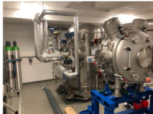
FIGURE – Caméra **pré-clinique** XEMIS2 installée au CHU-CIMA (Crédit photo : Laboratoire Subatech)
